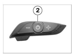
Um die Verbindung zwischen den Helmen zu unterbrechen, Taste 2 zweimal kurz betätigen (Wechsel in den Musikmodus).  Um die Verbindung zwischen den Helmen wieder herzustellen, Taste 2 erneut zweimal kurz betätigen.
