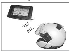
Jedem Helm mit Kommunikationssystem kann ein eigenes Navigationsgerät zugeordnet werden, ein Navigationsgerät kann jedoch nur einem Kommunikationssystem zugeordnet werden. Ob der Verbindungsaufbau zwischen dem Kommunikationssystem und dem Navigationsgerät automatisch erfolgt, hängt von dessen Einstellungen und Möglichkeiten ab. Bitte informieren
