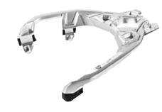
Die stabile Gepäckbrücke im ansprechenden Design ermöglicht die zuverlässige Befestigung des Topcase oder anderer größerer Gepäckstücke. Zudem dient sie dem Sozius als vollwertiger Haltegriff und kann auch optimal als Schiebehilfe beim Rangieren verwendet werden.
