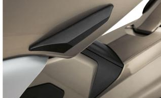
Die Sturzpads aus robustem Kunststoff schützen den Scooter im Fall des Falles vor Beschädigung. Die abriebfesten Pads werden vorn an die Verkleidung und hinten an die Trittbretter geschraubt und bieten einen effektiven Schutz bei Umfallern oder Stürzen bei geringer Geschwindigkeit.
