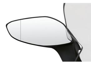
Das asphärische Spiegelglas vergrößert durch seine gebogene Oberfläche das Sichtfeld und eliminiert den toten Winkel fast vollständig.
